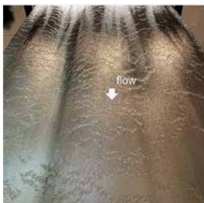
転波列現象(左),ダム破壊流れの実験(中),海洋モデルによる流れとマガキ幼生の輸送シミュレーションの結果(右)
